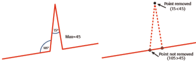
图 5：道路边线中的毛刺示意图
